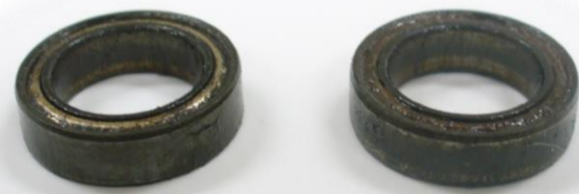
2年間メンテナンスされず使用されたシールドベアリング (φ15xφ13x4mm)
