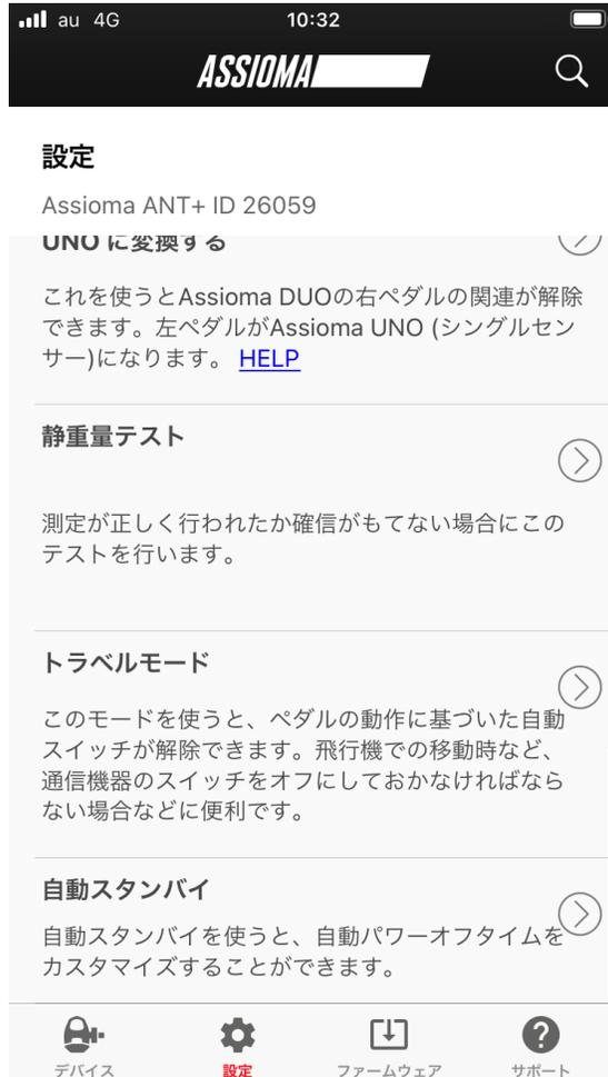
⑤静重量テストはゼロオフセット（校正）を行ったにもかかわらず測定値が不安定な場合や、他の測定精度±1%以下のパワー測定機器と比較して大幅に測定値が異なる場合に行います。
